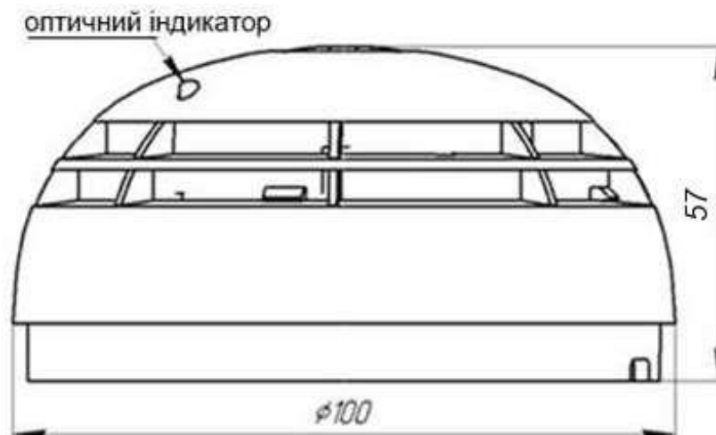
Малюнок 3 – Загальний вигляд оповісшувача. Габаритні розміри
