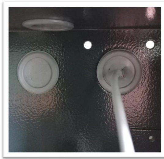
Малюнок 4 – Введення проводів для підключення
