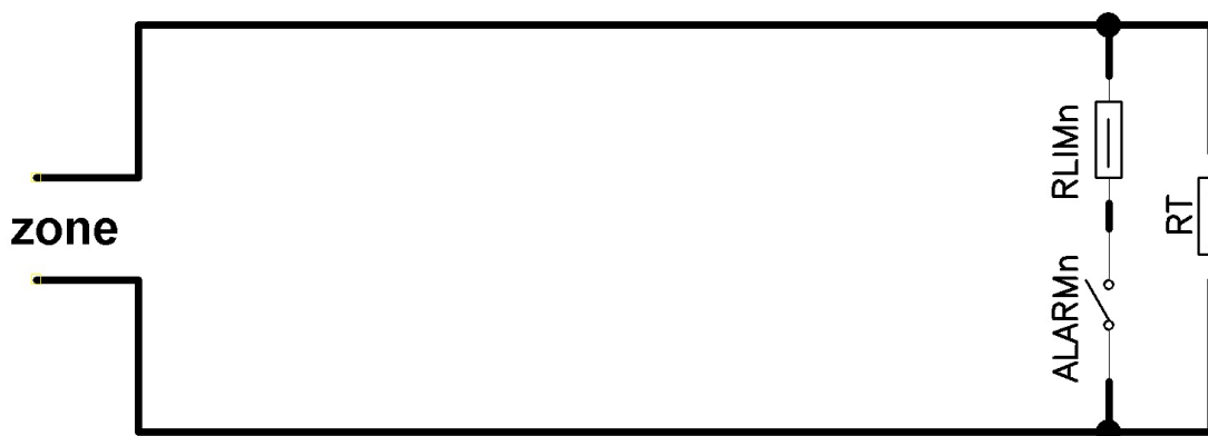
Рис. 2 – Подключение одиночных контактов «ALARM» блока к шлейфам сигнализации
