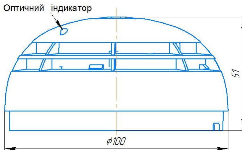
Малюнок 1– Загальний вигляд сповіщувача та габаритні розміри
