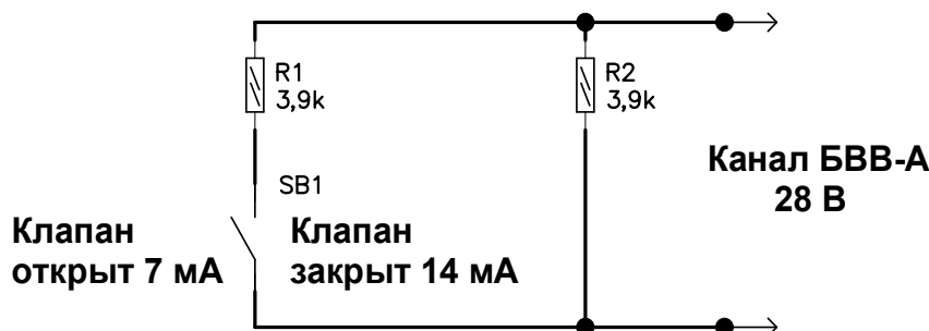
Рис. 8.25 Пример схемы «концевого выключателя» клапана дымоудаления
