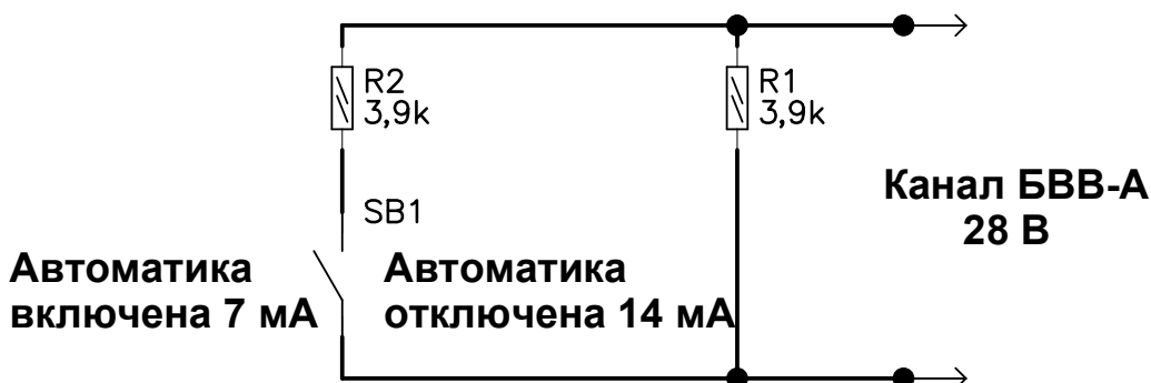
Мал. 8.19 Приклад схеми «кінцевого вимикача» ПУР 1, 2 БВВ-А
