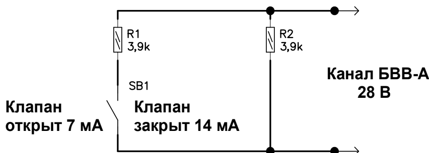
Мал. 8.25 Приклад схеми «кінцевого вимикача» клапана димовидалення
