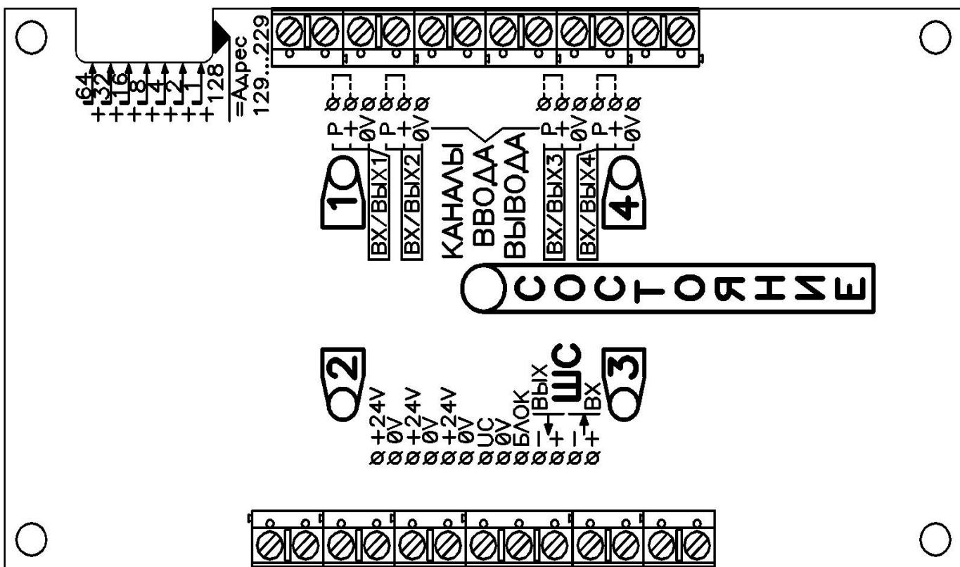
Зовнішній вигляд і розташування клем БВВ-А-01
