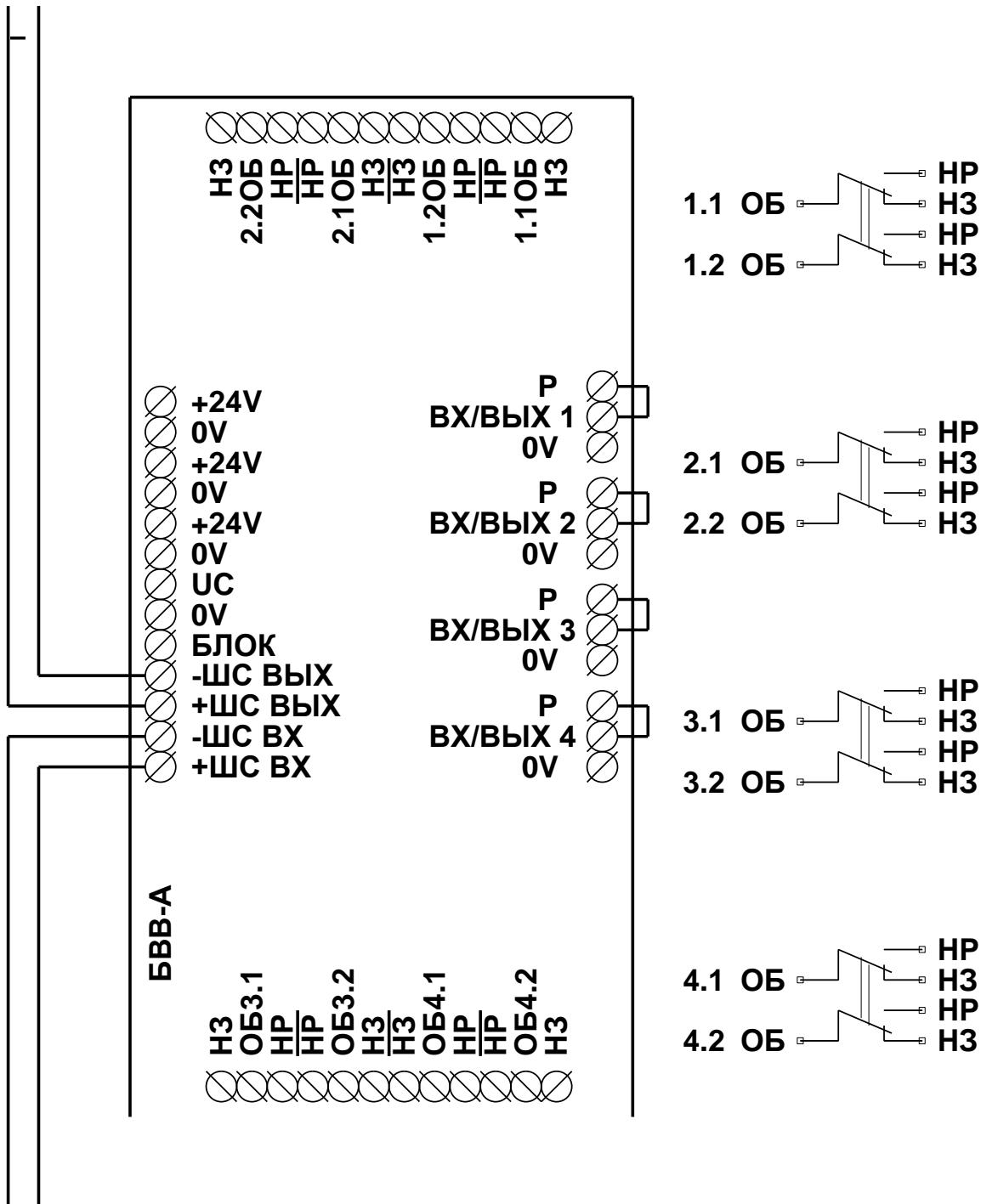
**Примітка.** При використанні реле (виконання БВВ-А-01) встановити перемички між клемами «P-ВХ / ВИХ1», «P-ВХ / вих2», «P-ВХ / ВИХ3», «P-ВХ / ВИХ4». Комутована контактами реле блоку БВВ-А-01 напруга не більше 42 В змінного або 60 В постійного струму, комутований струм не більше 2 А.
