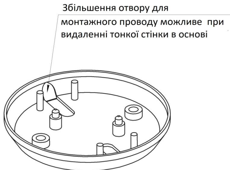
Малюнок 2– Підставка АКПИ.724222.007. Загальний вигляд, розташування вікна для кабелю.
